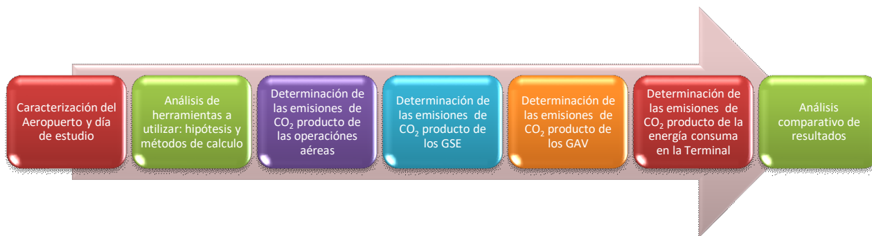
Figura 4 -Proceso lógico de trabajo para determinar la contaminación gaseosa
