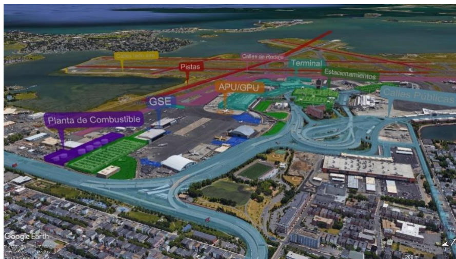
Figura 2 -Principales fuentes de emisiones gaseosas contaminantes en un aeropuerto.
