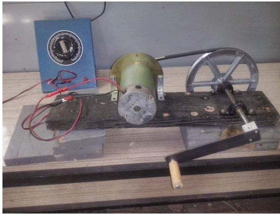
Figura 6: Generador CC de mayor potencia.
