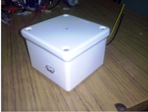
Figura 3: Regulador SEPIC en su gabinete terminado con led indicador de carga.
