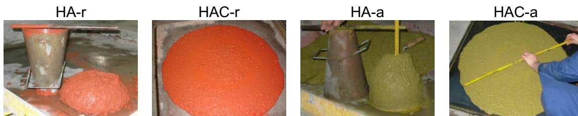
Figura 1 – Fluidez de los hormigones empleados en la fabricación de paneles de color
