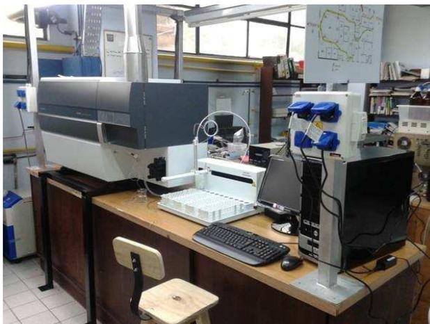
La versatilidad del equipo admite desde la detección de metales en aguas de consumo, industriales y residuales hasta matrices complejas como suelos, alimentos, materiales poliméricos, sueros. La tecnología de la mini antorcha de plasma redundante en una reducción de los costos de análisis con menor consumo de argón y energía.
