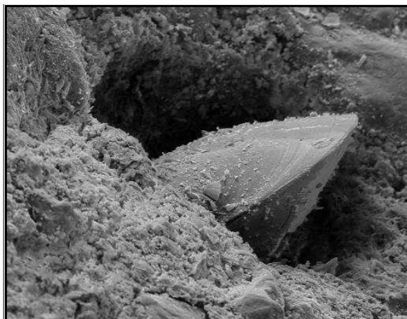
Figura 13.- Limnoperna fortunei incrustada en una probeta de pasta de cemento, 100x (fotografía SEM, microscopio electrónico de barrido)
