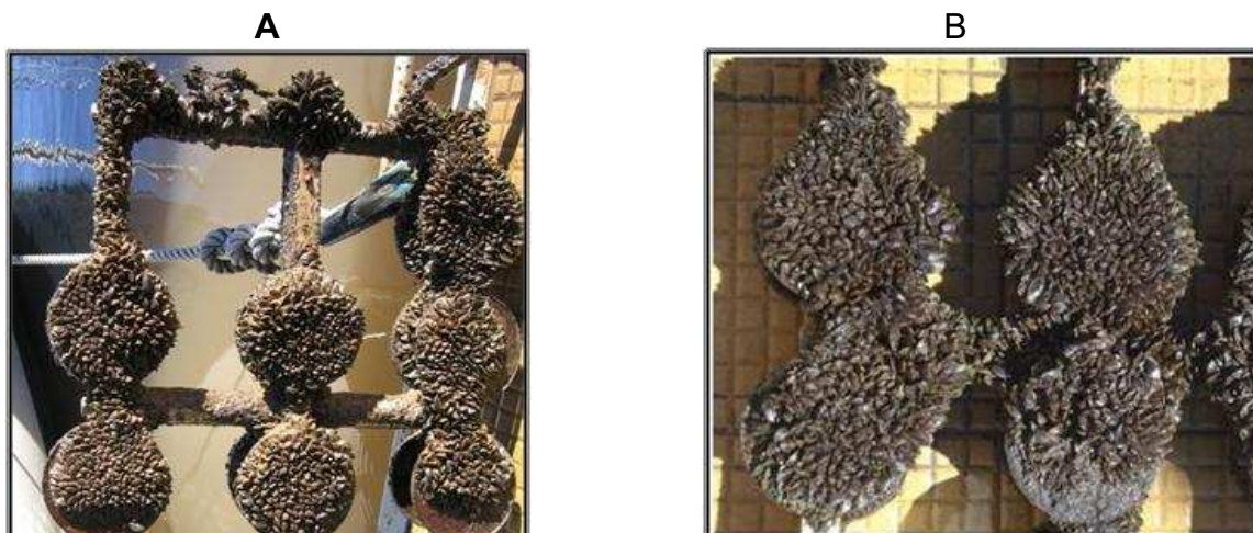
Figura 7. Aspecto del bastidor con probetas a/c 0,40. A: 12 meses de inmersión. B: 18 meses de inmersión
